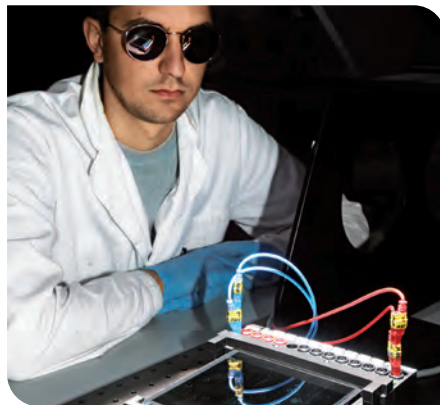
Unter dem Solarsimulator wird die Leistung der organischen Solarmodule gemessen
