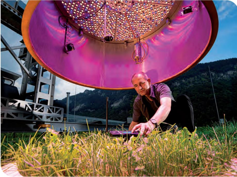
Das Eddy-Kovarianz-Messsystem misst den Austausch von Treibhausgasen zwischen Erdoberfläche und Atmosphäre
