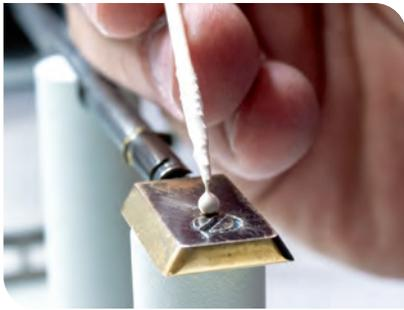
Vorbereitung einer Zementleim-Probe für die Untersuchung im Rasterelektronenmikroskop
