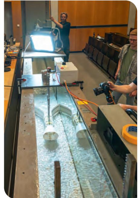
Plan, die Wasser zu einer Turbine leitet. Diese wird durch die Strömung bewegt und erzeugt Strom. Auf diese Art soll ein Flusskraftwerk simuliert werden. Ziel war es, die höchstmögliche Energieausbeute zu erreichen. Die Modelle wurden im Hörsaal in einer Versuchsrinne getestet. Das Besondere daran: Die acht Meter lange Versuchsrinne kann über einen Hebe-
