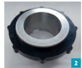
Abb. 2: Rohrprobekörper (16MnCr5), Da = 70 mm, Di = 50mm, 10 mm Kunst- stoffkomponente
