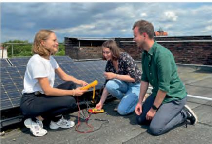
Studierende untersuchen Spannungen und Ströme an einer Photovoltaikanlage.
