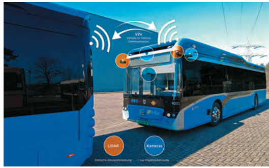
Entwicklung von bedarfsgerechtem und damit ressourcenschonendem Einsatz automatisierter Fahrzeuge im ÖPNV mit Hilfe von „virtueller Deichsel“ Copyright: KIT-ITIV
