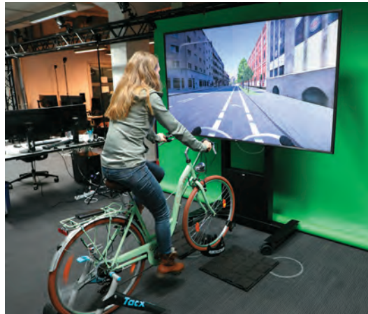
Abb. 8: Untersuchungen mit dem Fahrradsimulator zum Verhalten von Radfahrern (Foto: Daniela Ullmann)
