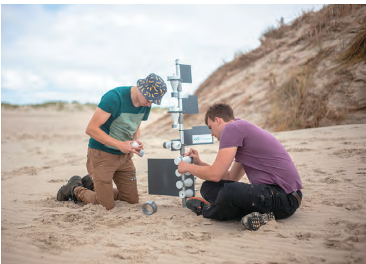
Abb. 1: Auf einer Spiekeroog-Exkursion installieren Studenten eine Sandfalle, um den Sandtransport infolge wehender Winde zu messen. Bild: Malte Kumlehn/ TU Braunschweig
