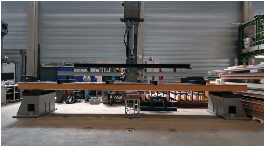
Biegeversuch an einem Sandwichelement mit Holzfaserkern
