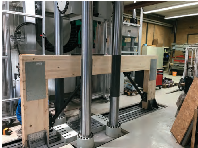
Prüfung von Holzrahmen mit Spannweite von 4,50 m.
