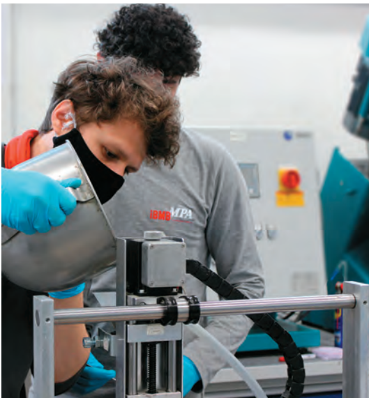
Abb. 2: Versuch zum Partikelbett-3D-Druckverfahren Bild: Inka Mai / TU Braunschweig
