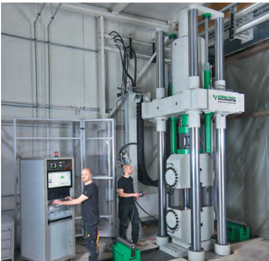
Mit der servohydraulischen 4-Säulen-Universalprüfmaschine (UP 2000 PK-4) werden umfangreiche Messungen durchgeführt und auch Studierende haben die Möglichkeit in Rahmen ihrer Abschlussthesis Versuche durchzuführen.
