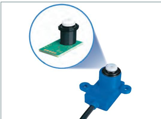
**Abb. 4:** Muster eines aktiven H<sub>2</sub>-Gassensors (L x B x H ca. 36 x 23/43 x 28 mm) zur Abgasüberwachung einer Brennstoffzelle im Fahrzeug/Detail Elektronik (L x B ca. 28 x 20 mm mit Gassensorkopf ca. Ø 13 mm)
