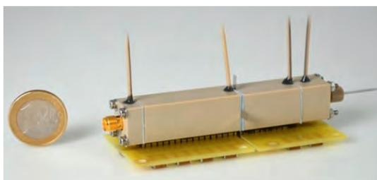
Abb. 2: Miniaturisiertes IMS mit Korona-Ionisationsquelle
