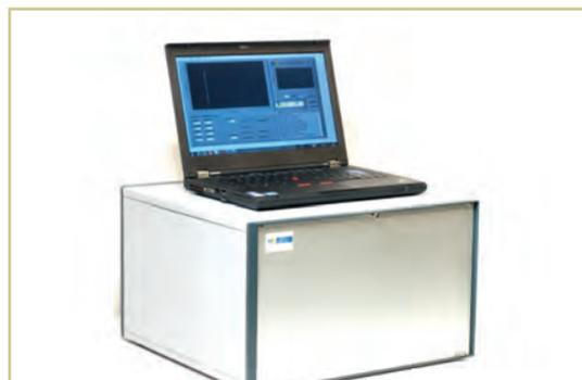
**Abb. 13:** Foto des GC-IMS mit integriertem Gaskreislauf
