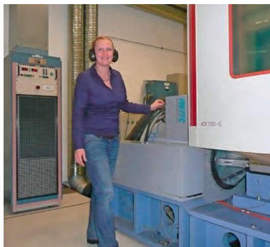
Abb. 2: Christina Maul mit elektrodynamischer Schwingprüfanlage im Gleittisch-Betrieb
