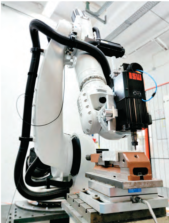
ABB.2: Industrieroboter mit gelenkseitiger Positionssensorik an den ersten drei Gelenken für die experimentelle Evaluation.
