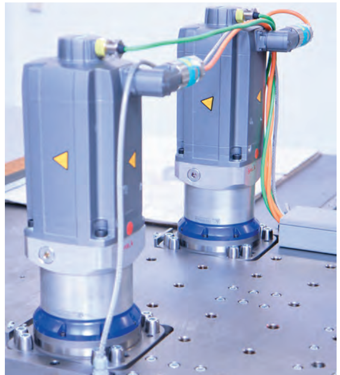
ABB.1: Versuchsstand mit Zahnstange-Ritzel-Antrieb am ISW.
