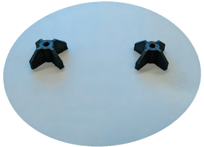
ABB. 3: Ein Versuchsbauteil mit direkt aufgedruckten Funktionselementen.
