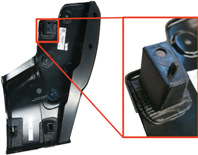
ABB.2: Ein Prototyp des Verfahrens. Das Funktionselement ist hier (noch) auf das Thermoformteil geklebt.
