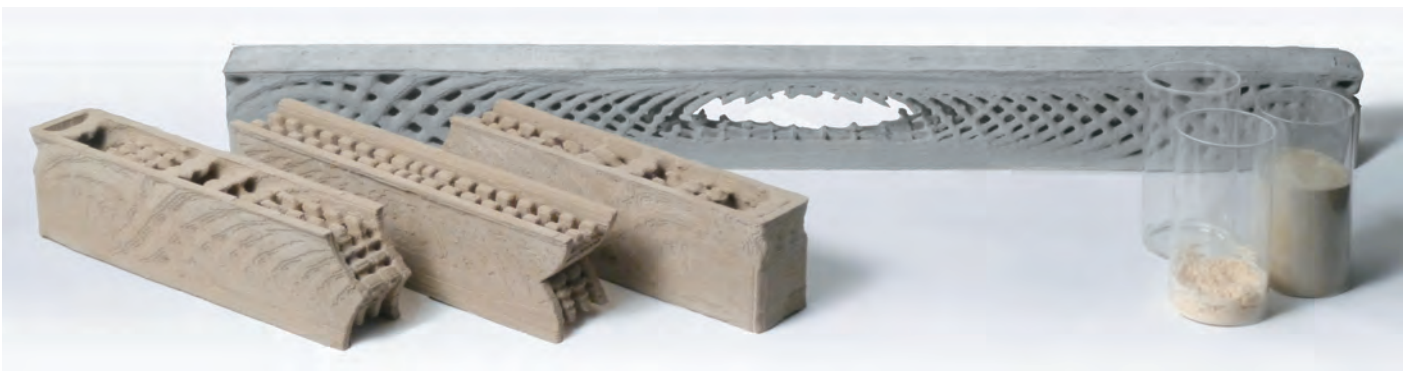
ABB.1: Leichtbau im Bauwesen – Strukturoptimierter Einfeldträger (mittig) aus Sandschalungssegmenten (links) und deren Rohmaterialien Sand, Wasser, Dextrin (rechts) (Bildquelle ILEK, Uni Stuttgart).
