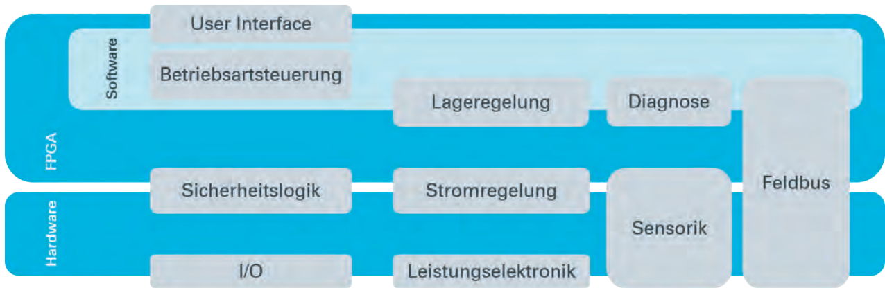
ABB.2: Ebenen und Komponenten der OAP.
