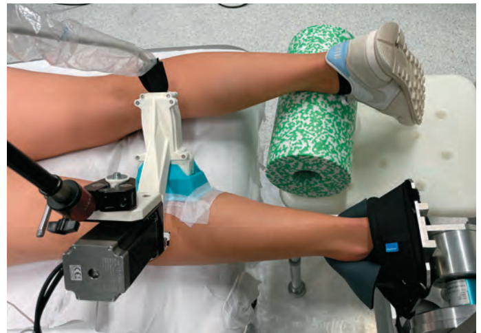
ABB.1: Aufbau zur automatisierten Ausrichtung der Ultraschallsonde aus der Summer School.
