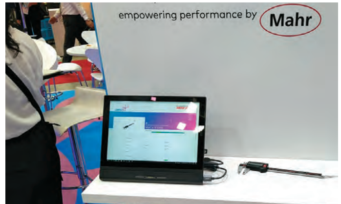
Das ISW unterstützt das umati Team auf der JIMTOF in Tokyo. Teil vom Showcase ( https://umati.app ) ist dieser smarte Messschieber. Er ist mit OPC UA for Geometrical Measurement Systems abgebildet, ein Standard, bei dessen Erstellung das ISW unterstützt.
