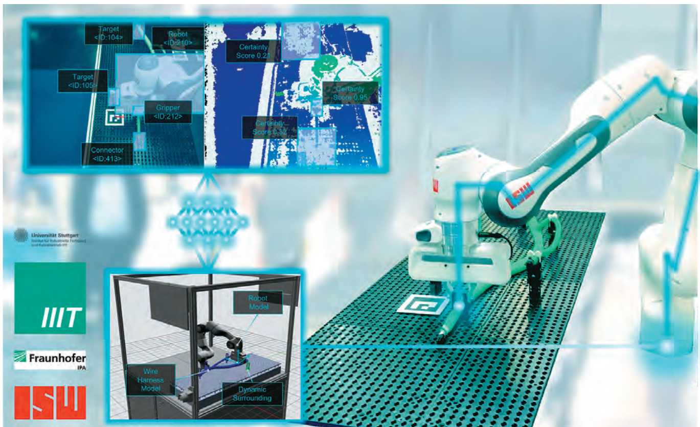
ABB.1: Konzept zur Nutzung von RGBD-Bilddaten und Simulation zur robotergestützten Manipulation von biegeschlaffen Bauteilen.
