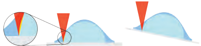
ABB.4: Links ist dargestellt, wie der Laser (rot) beim Bedrucken des Rohlings (hellblau) in Bereichen (gelb) durch diesen selbst gebrochen bzw. verschattet wird. Rechts ist dargestellt, wie durch ein relatives Neigen von Rohling und Laser zueinander das Problem umgangen werden kann [1].
