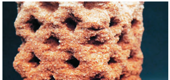
ABB.1: Mittels Additiver Fertigung hergestellter Probekörper aus Biobeton.
