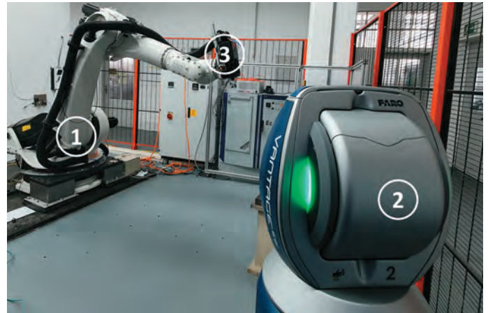
ABB.4: Validierung der Endeffektor-Genauigkeit (3) des Roboters (1) mittels Lasertracker (2).
