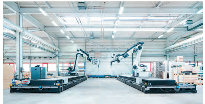
ABB.1: Das off-site Fertigungssystem bestehend aus zwei Roboterplattformen, Quelle: Universität Stuttgart, IntCDC.
