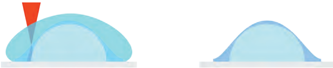
ABB.3: Links dargestellt ist der sphärische Linsenrohling (hellblau Halbkugel) auf welcher ein Tropfen Fotolack (hellblau) platziert ist. Der kegelförmige Laser (rot) deutet die zu schreibende asphärische Kontur (dunkelblau) an. Rechts ist die fertig gedruckte Linse dargestellt [1].
