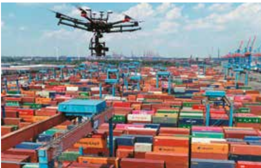
Abb. 3: Drohne der TU Braunschweig bei der automatisierten Vermessung von Schieneninfrastruktur am Hamburger Hafen Bild: IFF&IGP/TU Braunschweig
