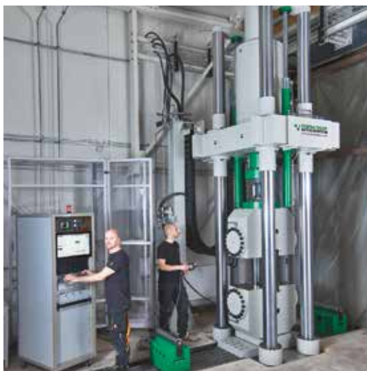
Mit der servohydraulischen 4-Säulen-Universalprüfmaschine (UP 2000 PK-4) werden umfangreiche Messungen durchgeführt und auch Studierende haben die Möglichkeit in Rahmen ihrer Abschlusssthesen Versuche durchzuführen.
