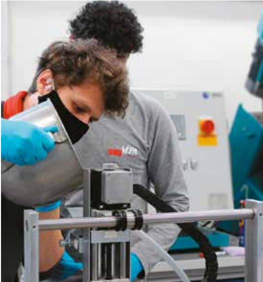
Abb. 2: Versuch zum Partikelbett-3D-Druckverfahren Bild: Inka Mai / TU Braunschweig
