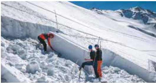
Versuchsfeld Schneeprofil und Brucheigenschaften der Schneedecke. Foto: Philipp Rosendahl
