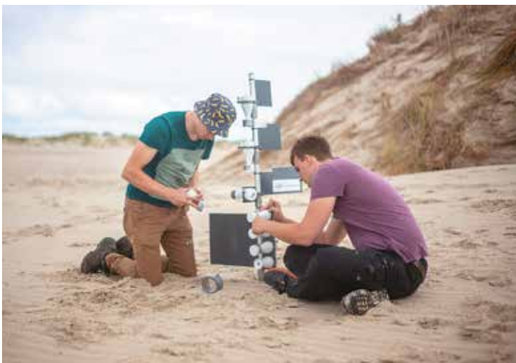
Abb. 1: Auf einer Spiekeroog-Exkursion installieren Studenten eine Sandfalle, um den Sandtransport infolge wehender Winde zu messen. Bild: Malte Kumlehn/ TU Braunschweig
