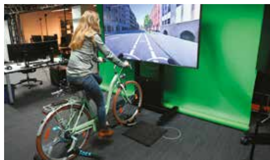
Abb. 9: Untersuchungen mit dem Fahrradsimulator zum Verhalten von Radfahrern (Foto: Daniela Ullmann)
