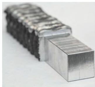
**Abbildung 2:** WAAM-Bauteil aus Aluminium mit charakteristischem Schichtaufbau (links) und geräster Oberfläche (rechts) (Foto: Lukas Oster – Plasma Additive Labs)
