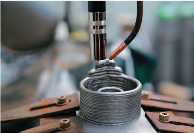
**Abbildung 4:** MSG mit Zusatzdraht für die additive Fertigung mit erhöhten Abschmelzleistungen, (Foto: Lukas Oster – Plasma Additive Labs)
