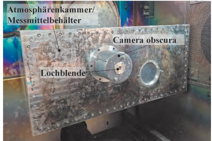
**Abbildung 2:** Höhenverstellbare Atmosphärenkammer zur Aufnahme der Messgeräte in der Vakuumkammer einer Elektronenstrahlschweißanlage
