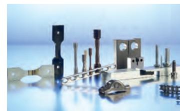
Typische Proben für Ermüdungs- und Bruchmechanische Prüfungen
