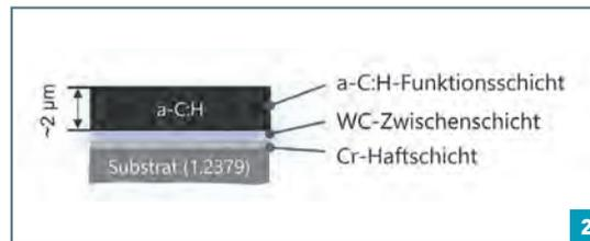
**Abb. 2:** Schematische Darstellung der grundlegenden Schichtarchitektur der amorphen Kohlenstoffschichten (a-C:H). Quelle: Uni Bayreuth
