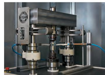
Komponenten auf Ermüdung prüfen mit der RUMUL GIGAFORTE bei 1000Hz Prüffrequenz
