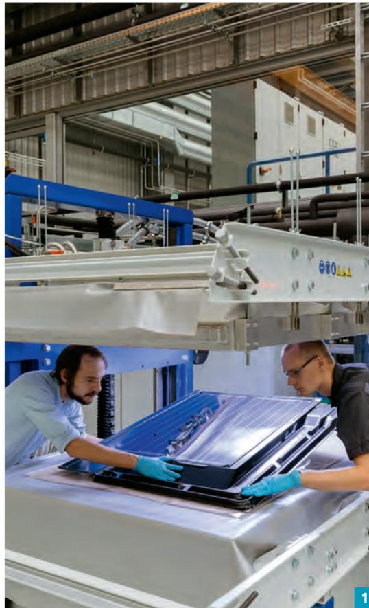
**Abb. 1:** Am 3D-Vakuumlaminator lassen sich Solarmodule mit gebogenen Formen verarbeiten. Foto: ©Fraunhofer CSP/ Sven Doering
