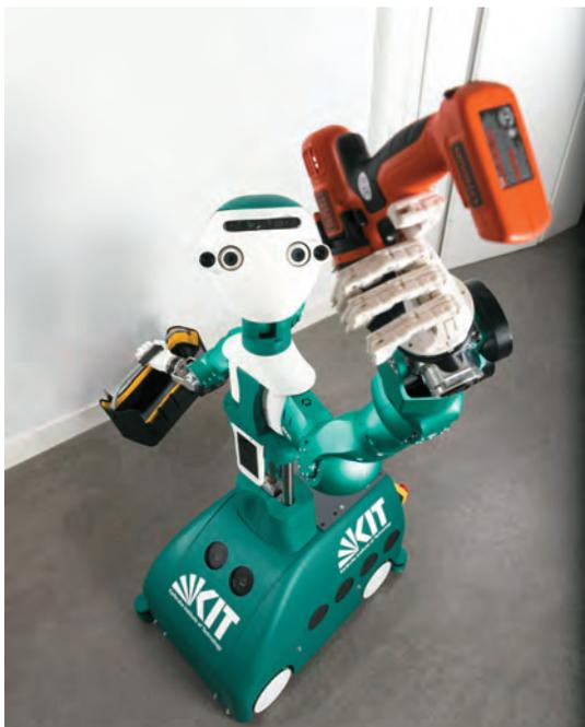
Der humanoide Assistenzroboter ARMAR-6 wird am KIT entwickelt um in industriellen Umgebungen direkt mit Menschen zu interagieren.
