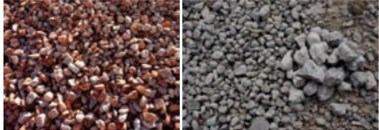
**Fertig aufbereitete rezyklierte Gesteinskörnung aus Bauabbruchmaterial für den Einsatz im Recyclingbeton: links Abbruchmaterial aus Mauerwerk mit erhöhtem Ziegelanteil rechts nahezu reines Betonabbruchmaterial**
