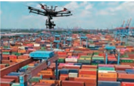
Abb. 3: Drohne der TU Braunschweig bei der automatisierten Vermessung von Schieneninfrastruktur am Hamburger Hafen
