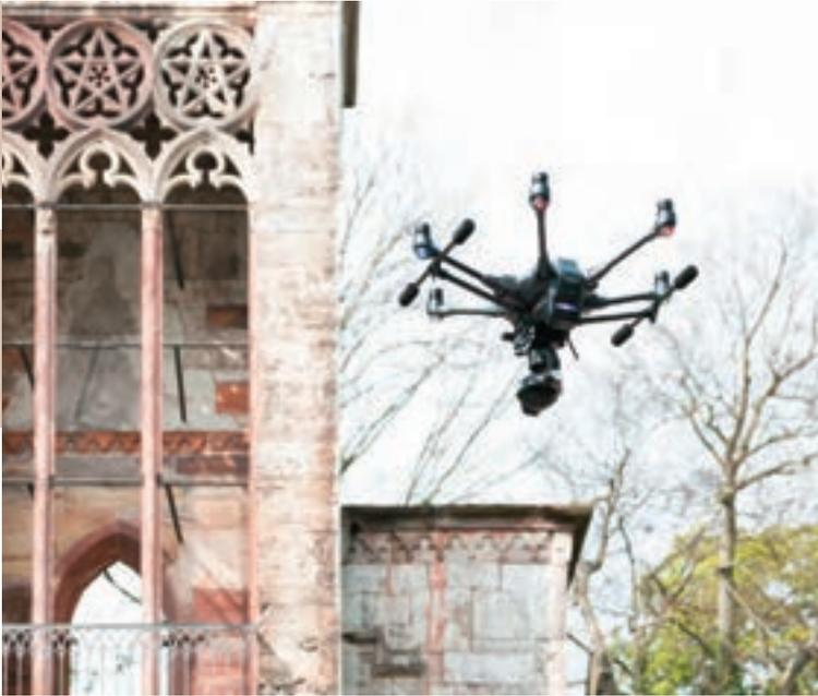
Forschung am Puls der Zeit: Mithilfe von Drohnen werden Bauwerke aus der Luft inspiziert und in digitale 3D-Modelle überführt.
