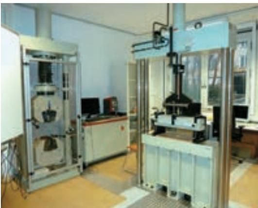
**Abb.4: Zug- und Biegeprüfanlage im Baustofflabor an der THN**
