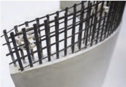
Eine Bewehrung aus speziellen Kohlefasern macht Carbonbeton besonders leistungsfähig, Bild: Ulrich van Stipriaan
