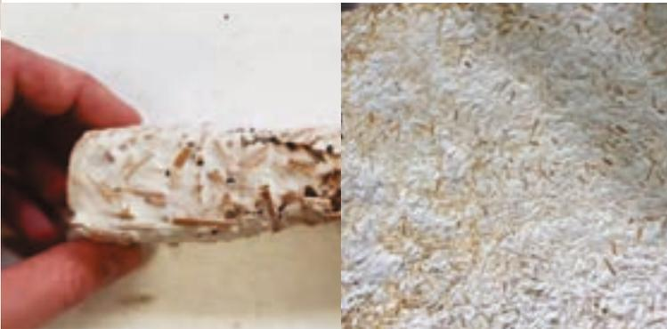
Bild 3: Dämmstoff aus einer Kombination aus Schimmelpilz und Schilfgras [Dias et al. 2021]
