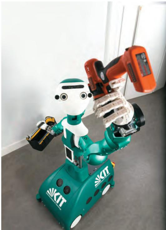
Abb. 1: Der humanoide Assistenzroboter ARMAR-6 wird am KIT entwickelt, um in industriellen Umgebungen direkt mit Menschen zu interagieren.
