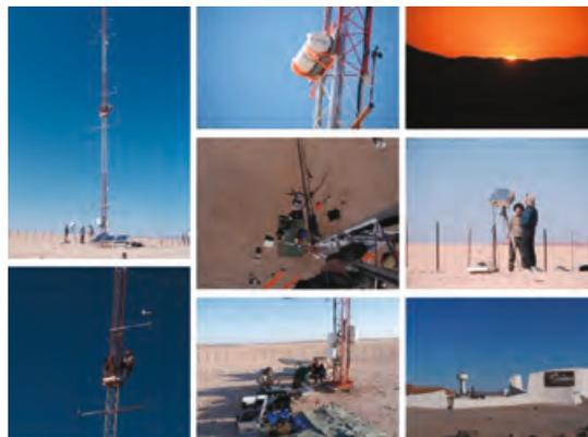
+60 °C tagsüber. Sandstürme und Regen stellen hohe Anforderungen an die verwendeten Materialien gegenüber Abrasion und Korrosion. Dies gilt für die eingesetzte Optik genauso wie für die Gehäusematerialien.
