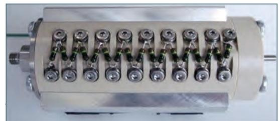
**Abb. 4:** Kompaktes IMS (75 mm Driftlänge) mit ultra-hohem Auflösungsvermögen.
