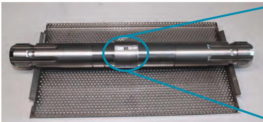
Abb. 1: „BiSWind“-Demonstratorwelle mit mittig angeordneten Mess-Halbschalen
