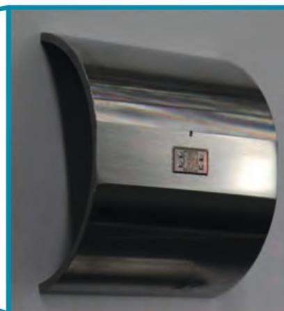
Abb. 2: Halbschale mit aufgeschweißter DMS-Brücke vor der Endmontage
