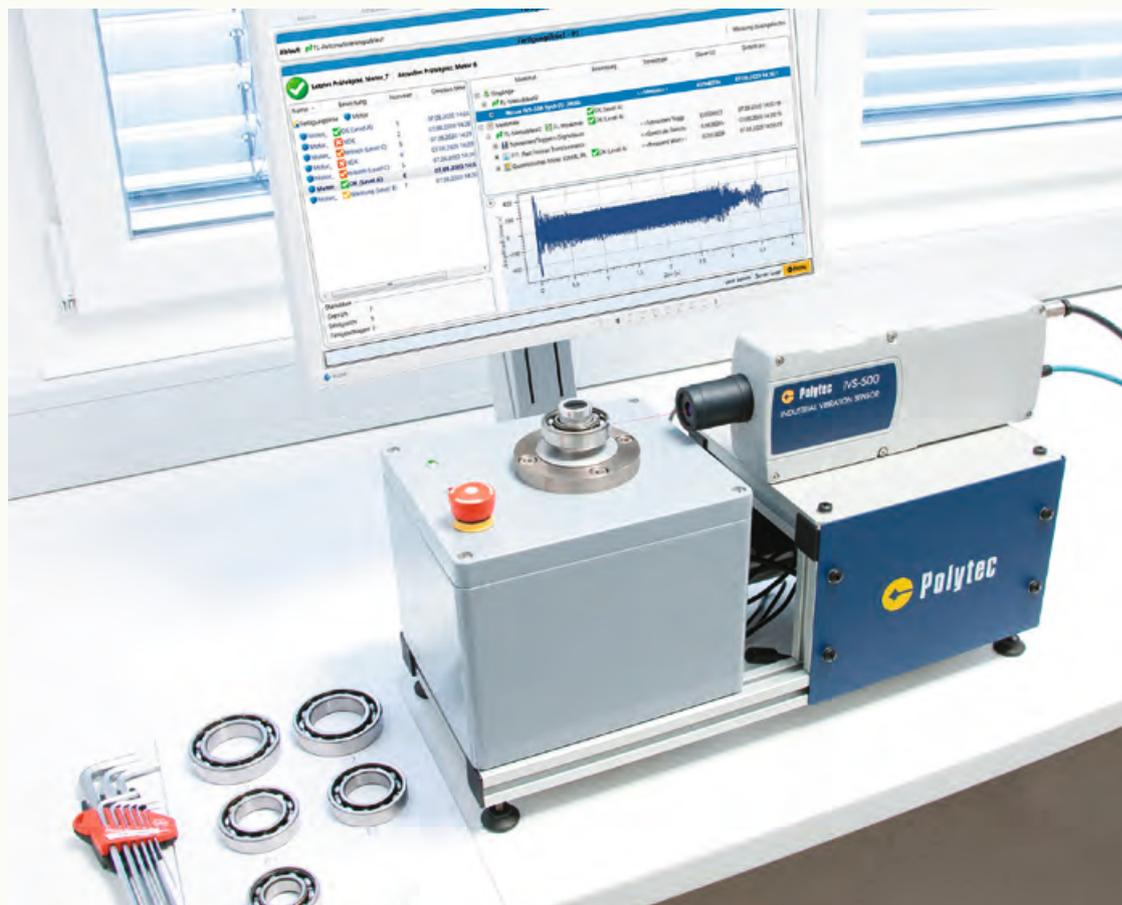
**Abb.:** Akustische Prozess- und Qualitätskontrolle leicht gemacht: Industrievibrometer und leistungsfähige Prüfsoftware als Komplettlösung. (Urheber: Polytec)
