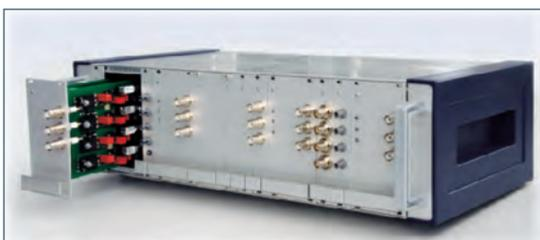
Abb. 15: Modulare Messelektronik für die Sensorentwicklung
