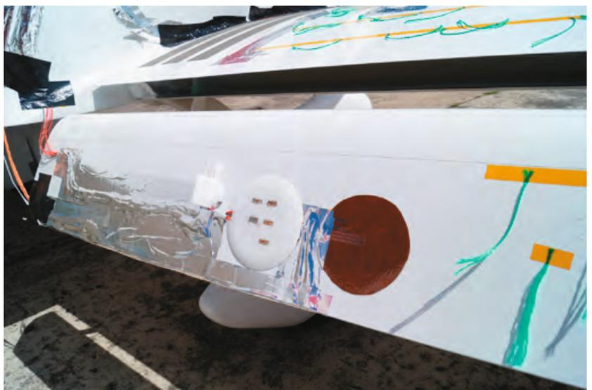
Abb. 4: Faseroptische Drucksensoren auf einer Tragfläche eines Kleinflugzeuges
