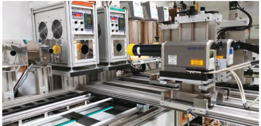
Abb. 1: Kalibrierlabor der Fa. HEITRONICS. Ganz links sind 2 elektrisch beheizte Hohlraumstrahler zu sehen. Rechts daneben befinden sich 2 Flüssigkeitsstrahler mit einer Apertur von 60 mm. Im rechten Bildbereich sind 2 Transfer Strahlungsthermometer zu erkennen, die sich auf einem Schienensystem befinden. Damit ist es möglich die beiden IR Thermometer vollautomatisch und punktgenau vor dem jeweiligen Strahler zu positionieren.
