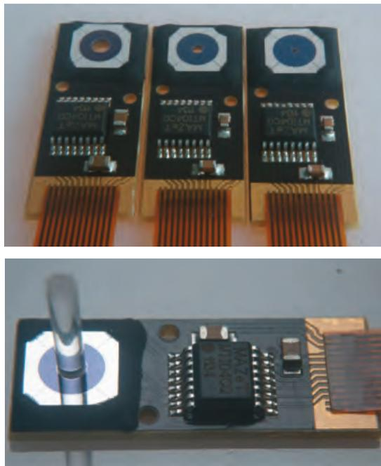
**Abb. 4:** 4-Quadranten-Fotodetektor mit durchgeführter GRIN-Linse für die Strahlverfolgung in einem Laser-Tracker-System.
