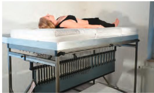
Abb. 3: Legt sich ein Proband auf die Matratze, verformt sich die Oberfläche und die Sensoren erfassen die Tiefe des Einsinkens. (Urheber: Forschungsgruppe Industrieanthropologie der Christian-Albrechts-Universität in Kiel)
