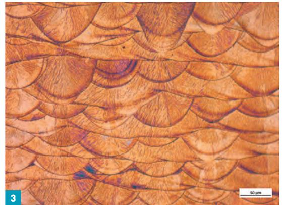
Ebenso können mit speziellen Ätzmitteln Elementkonzentrationsunterschiede, Verformungen oder Phasen sichtbar gemacht bzw. stärker kontrastiert werden. In Verbindung mit speziellen Kontrastmodulen im Lichtmikroskop ergeben sich damit Untersuchungsmöglichkeiten, die nicht nur aufschlussreich sein können, sondern auch dem Betrachter die Schönheit mikroskopischer Strukturen sichtbar machen (Abb. 2 und 3).
