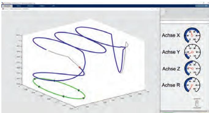
ABB.2: Bahngenauigkeit einer Raumkurve bei unterschiedlichen Dynamiken und Aufsynchronisierung von einzelnen Achsen je nach Arbeitsraumposition
