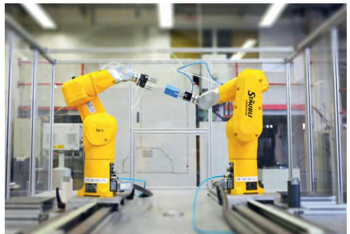
ABB.1: Praktikumszelle mit zwei Stäubli TX-40 Knickarmrobotern
