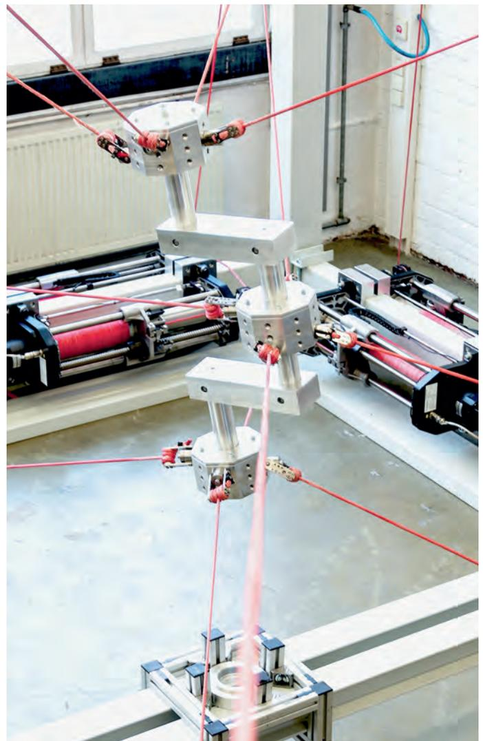
ABB.1: Versuchsstand für Seilroboter mit endloser Rotationsmöglichkeit
