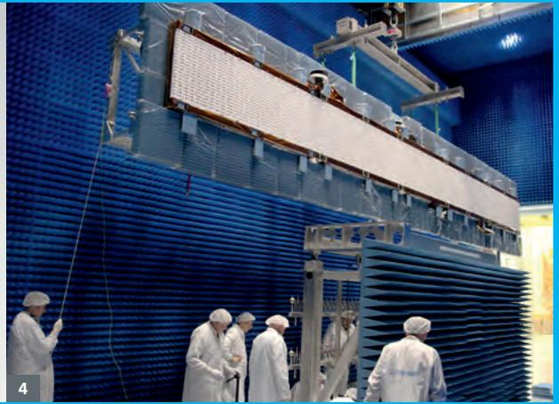
**Abb. 4:** Radarantenne der Sentinel 1-Satellitenserie während der Montage. © Airbus Defence and Space GmbH
