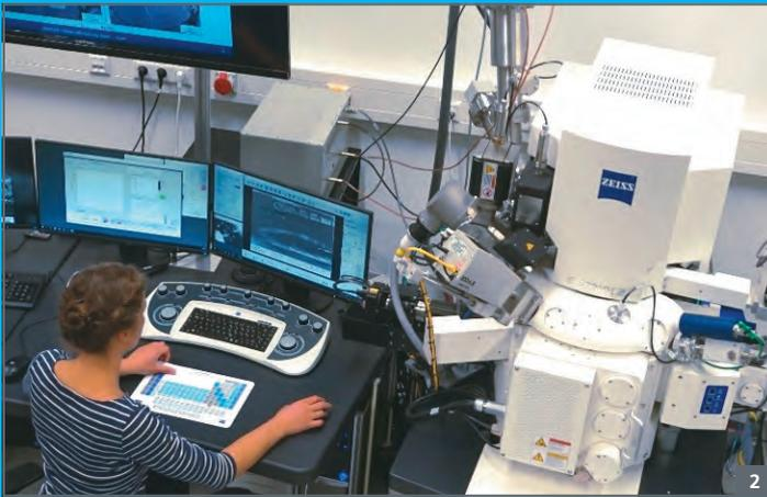
**Abb. 2:** Kombination Rasterelektronenmikroskopie und Massenspektrometrie bestehend aus Hiden Analytical EQS Secondary Ion Mass spectrometry und Zeiss Crossbeam 540
