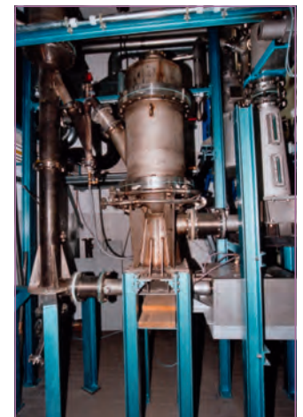
Abbildung: Zweisträngige und zweistufige Vergasungsanlage zur Erzeugung eines wasserstoffreichen Produktgases
