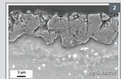
Abbildung 2: REM-Aufnahme eines Querschliffes der Ultraceramic®-Oberfläche auf Magnesium
