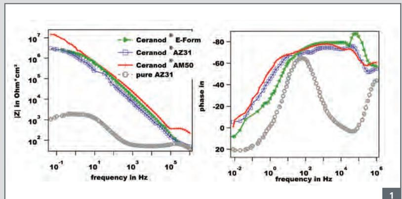
Abbildung 1: Elektrochemische Impedanzmessungen an Ultraceramic®-Schutzschichten, erzeugt auf unterschiedlichen Magnesium-Legierungen
