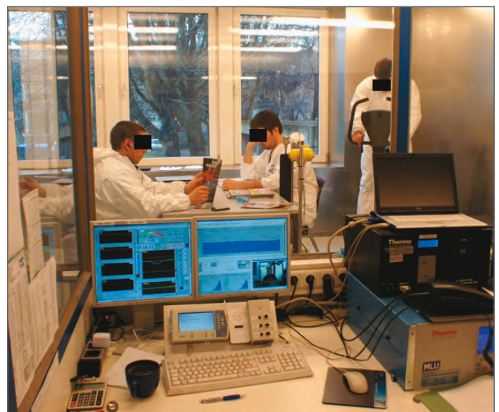
Abbildung 1: Kontrollraum und Expositionsraum der Aachener Arbeitsplatzsimulationsanlage während einer Expositionsstudie.
