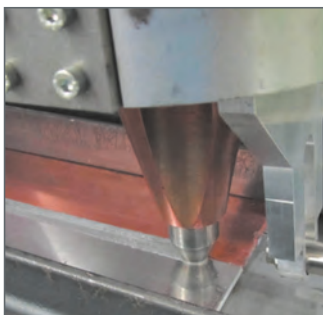
Abbildung 5: Rührreißschweißen einer Al-Cu-Mischverbindung (links) und Schliffbild einer rührreißgeschweißten Al-Stahl-Mischverbindung (rechts)
