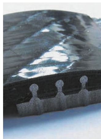
Abbildung 5: CMT-Pinstrukturen (links), Hybridverbund aus CFK und Stahl (rechts) (© ISF)
