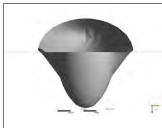
Abbildung 5: Vergleich von Querschnitten des Schweißbades für die Fälle Goldak's ÄWQ mit 2.Modifikation (links), ÄWQ MR10 nach Mokrov (mitte) und Experiment (rechts)
