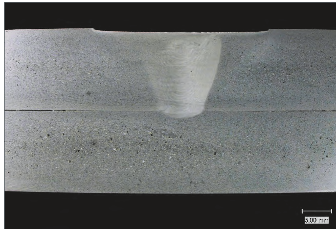
Abbildung 2: Querschnitt einer klebstofffixierten Überlapp-Rührreibschweißverbindung am Beispiel von zwei 14 mm dicken Aluminiumgussplatten (Schweißen erfolgte durch den Klebstoff)
