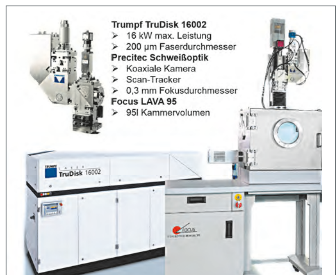
Abbildung 7: Versuchsanlage LaVa 16 kW
