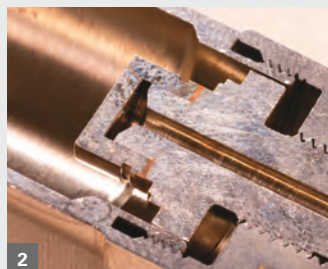
Abb. 2: Druckaufnehmer aus der Sensorindustrie. Verbindung zwischen Titan und Edelstahl mit Hilfe einer Kupfer-Zwischenschicht
