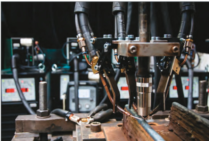
Abbildung 1: MSG-Mehrdraht-Brenner und Heißdrahtstromquellen für bis zu drei Zusatzdrähte für die additive Fertigung mit erhöhten Abschmelzleistungen
