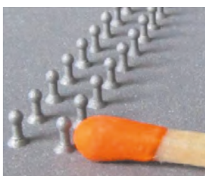
Abbildung 4: Pinstrukturen, welche mittels unterschiedlicher Verfahren erzeugt wurden (von links nach rechts: CMT-Pins, Surf-Sculp Strukturen aus Titan [BH11], HYPER-Pins aus Titan [PBM+14], HYPER-Pins aus Aluminium [PSG+14])
