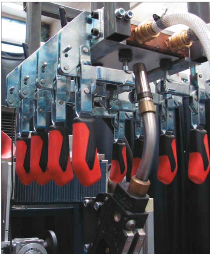
Abbildung 1: Schweißvorrichtung zum mechanisierten Schweißen Überkopf-Position
